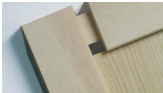
Assemblage par tenon et mortaise
