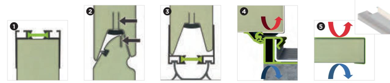
1 Profil haut en aluminium à rupture de pont thermique. Supprime le point de rosée.
